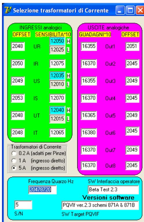
L'operatore deve cambiare la selezione del Trasformatore di corrente da 5 A (ingresso diretto) a 0.2 A (adatti per pinze) come nella seguente figura:
