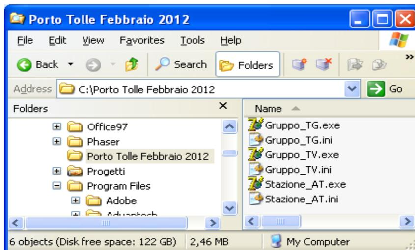
Attenzione che, se successivamente si cambia lo strumento PQVIf, per il collegamento allo stesso impianto, è necessario cancellare il file **ini** per poter riassegnare la porta. Ogni strumento, infatti, genera nel PC una porta COM associabile solo a se stesso, in corrispondenza biunivoca.
