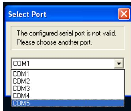
A questo punto, dopo aver scelto la porta giusta, appare la finestra dell'applicazione, come nella figura riportata di seguito, che riguarda lo strumento numero 5 (il serial number nell'angolo in alto a sinistra) collegato alla porta COM 5 (seconda finestrella in alto a sinistra)
